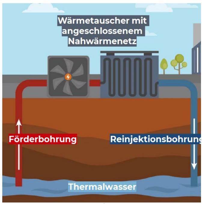
Schematische Darstellung der Tiefengeothermie: Über die rote Leitung kommt das warme Wasser, das abgekühlte Wasser wird über die blaue Leitung wieder in die Malm zurückgepumpt. Es entst kein Massendefizit.
