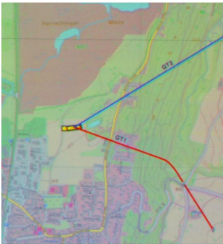
Skizze von den geplanten Bohrpfaden: Der Bohrer arbeitet sich zuerst rund 800 Meter vertikal in die Tiefe und biegt dann in einem sanften Winkel ab. Die rote Linie kennzeichnet das Rohr zur Entnahme des heißen Wassers, in der blauen Leitung wird das abgekühlte Wasser wieder in den Untergrund gepumpt. Der gelbe Fleck markiert das Bohrfeld. Von dort arbeitet sich der Bohrer in die Tiefe. Dieses Feld liegt zwischen Gewerbegebiet und Seefelder Straße.
