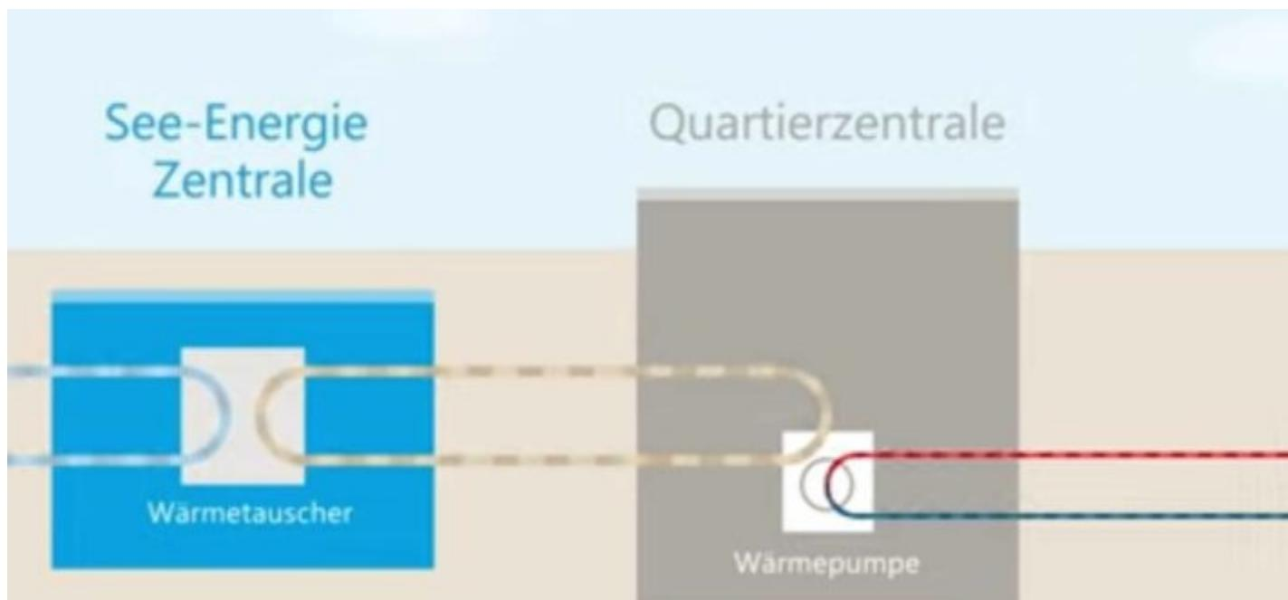
*Schematische Darstellung der Seewärme. Ganz links: Das Seewasser gibt die Wärme an einen Tauscher ab und wird naturbelassen, aber kälter, wieder in den See zurückgeleitet. Ein weiteres abgeschlossenes Netz transportiert die gewonnene Wärme zu den Wärmepumpen. Von dort geht, wiederum in einem geschlossenen Kreislauf, das Warmwasser zu den Haushalten.*
