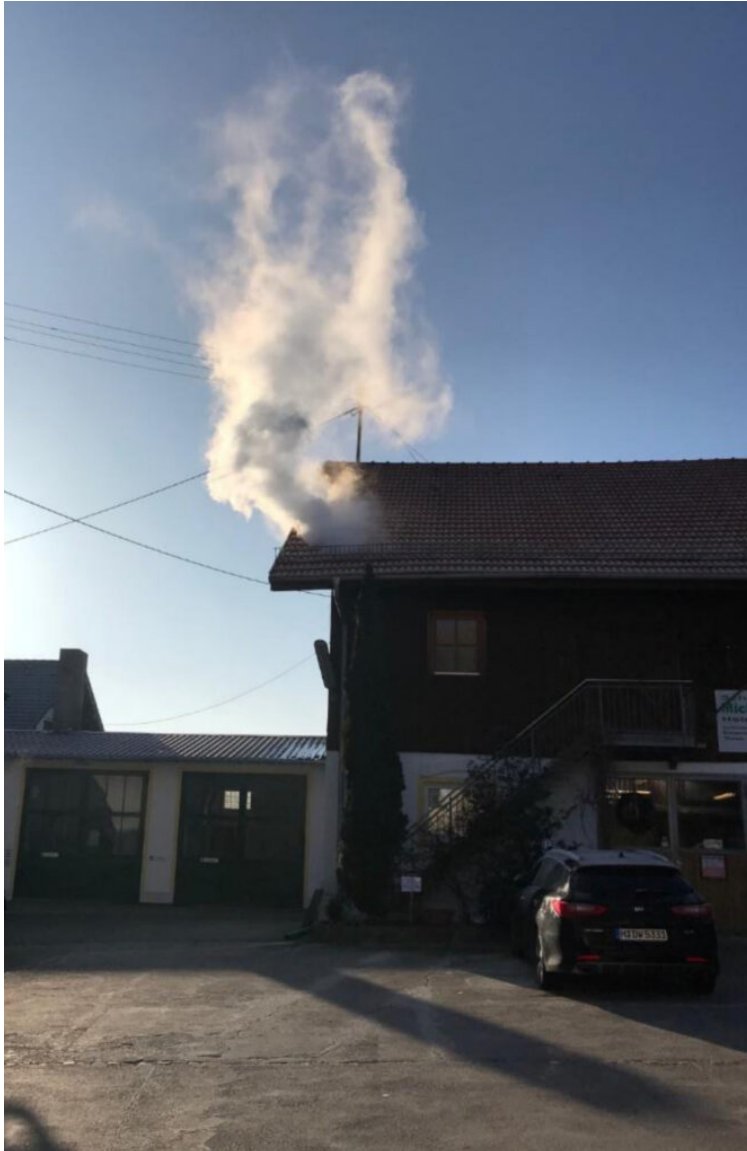
Disconebel aus der Dachrinne: Mit Glycerin ermittelt die AWA, welche Dächer an die Regenwasser-Kanalisation angeschlossen sind.
